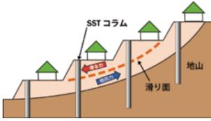
【設計基準強度】2,400KN/m<sup>2</sup>
